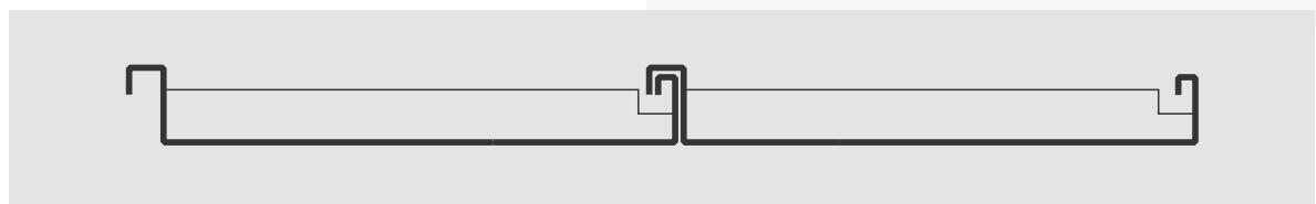
Схема раскладки панелей типа «D» на элементах подвесной системы
