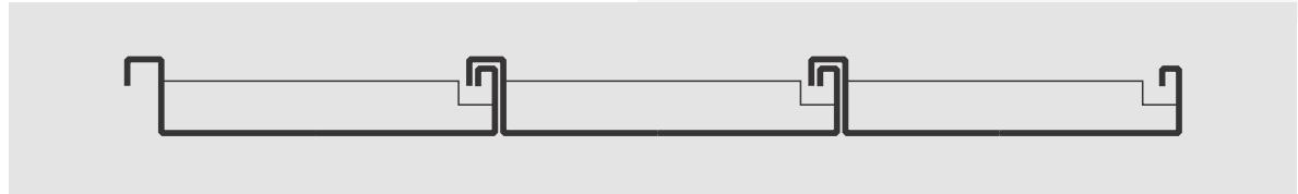
Схема раскладки панелей типа «В» на элементах подвесной системы
